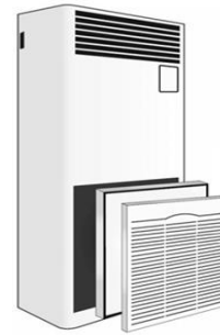
Fan Coil Unit
